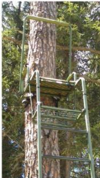
Einfache Jagdeinrichtung aus Metall (Ansitzleiter), Befestigung mit Zurrgurten am Baum, leicht und flexibel
